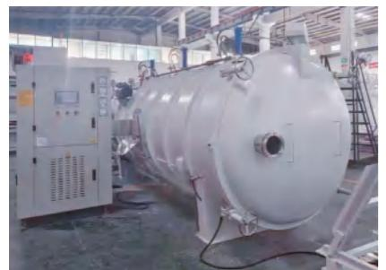
HV-F真空高频材料处理仓，是吉他生产前材料稳定性的最后一道关卡，它内部集成了高频发生器、真空负压系统和蒸汽冷却机等众多仪器与工序过程，它不是简单的高温烘干，而是对已经得到自然风干的木材，多次进行技术处理，释放应力，再处理，再释放，如此反复多次，彻底释放木材潜力，获得更高的稳定性基础。
